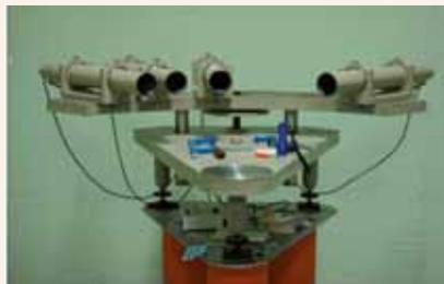
*Colimador angular para la calibración de limbos en teodolitos (Laboratorio de Topografía)*
