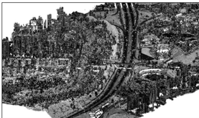
Figura 5. Nube de puntos LiDAR representada según la intensidad registrada por el sensor
