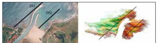
Figura 6. Ajuste entre pasadas, en zona de agua. Perfil ZA1 trazado sobre fondo rocoso, y el perfil ZA2 en fondo dunar
