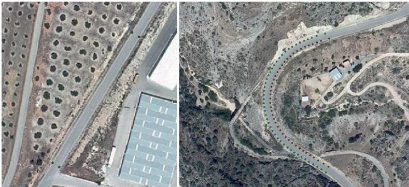
Figura 2. Levantamiento RTK. A la izquierda, levantamiento de la recta con 4 puntos. A la derecha, levantamiento de la curva con puntos tomados a lo largo de la misma
