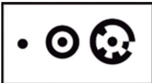
Figura 1. De izquierda a derecha, Dots, RAD Dots, y RAD Coded
