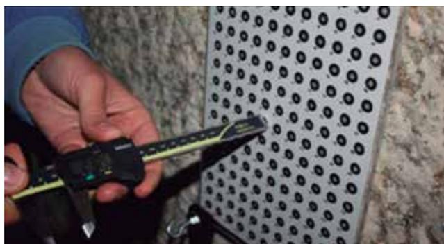
Figura 4. Detalle de las mediciones realizadas con el calibre para la evaluación de precisión
