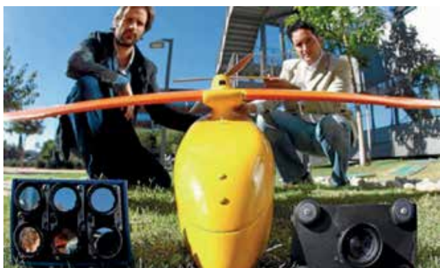
Figura 1. RPAS de diseño y fabricación propia junto con diferentes modelos de sensores multispectrales (Periódico El Mundo)
