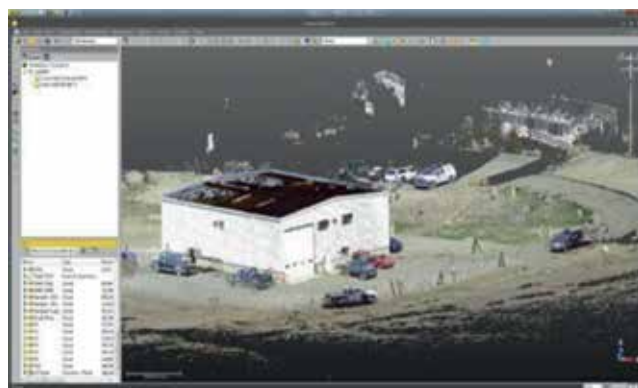
Figura 7. Nube de puntos coloreada en Trimble RealWorks, tomada con el Trimble TX5 3D Laser Scanner
