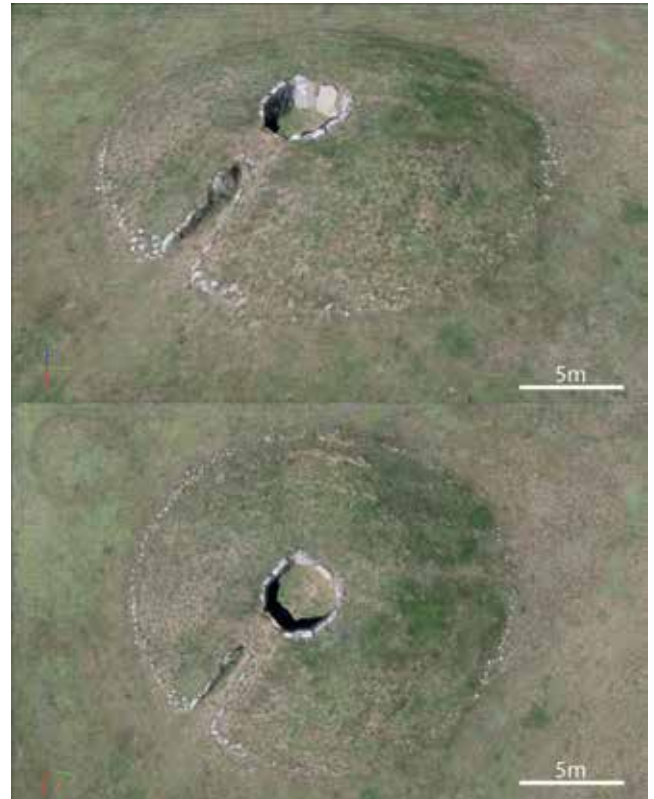
Figura 8. Perspectivas reproducidas con un mosaico de 57 imágenes tomadas con VANT sobre modelo digital de superficie (MDS) obtenido por fotogrametría
