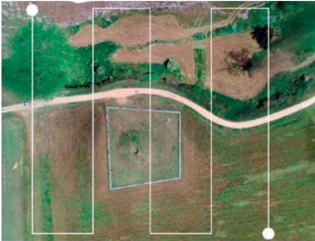
Figura 3. Planificación de vuelo con VANT y área cubierta en este trabajo
