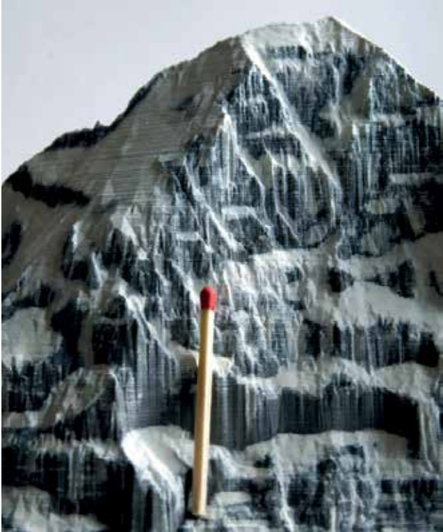
Figura 12. Detalle de Eiger (Suiza) 1:12.500 Mika Semann, Creado usando técnicas de prototipado rápido con capas de 0.15mm de espesor. (Swiss Alpine Museum)
