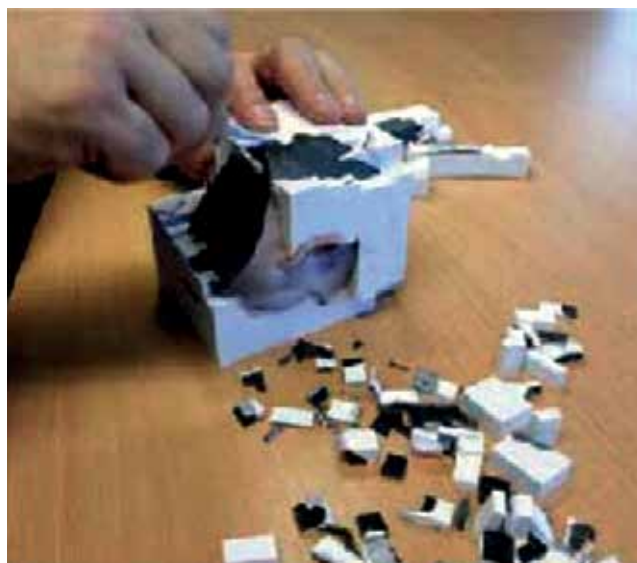
Figura 15. Impresión 3D de Mcor's: eliminando el material. (Mcors, 2013)
