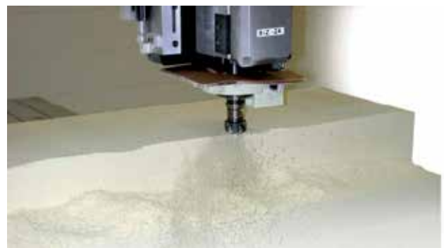
Figura 6. Máquina de corte de STM. (SolidTerrainModeling, 2002)
