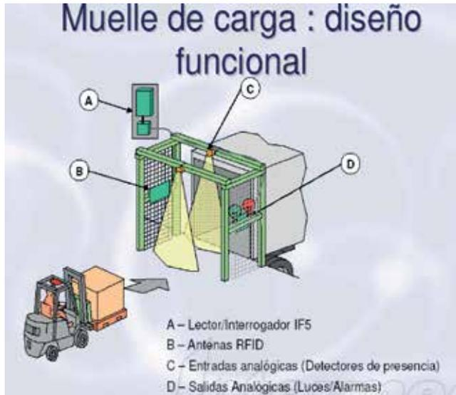
Figura 18. Muelle de lectura de productos a la entrada y salida de un contenedor [14]. Fuente internet
