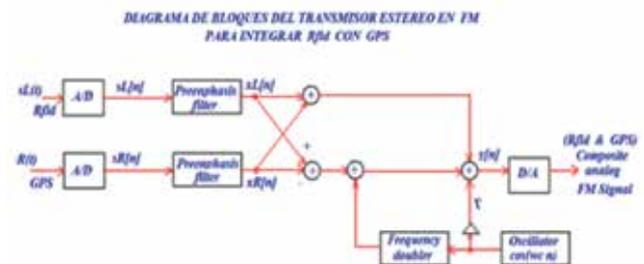
Figura 15. Bloques del modelo de transmisión para las tramas RFID y GPS en FM
