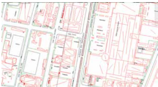
Figura 3. Restitución fotogramétrica digital, información actualizada de linderos y construcciones. Cartografía Catastral del Municipio, se observa los lotes, bloques constructivos y claves catastrales
