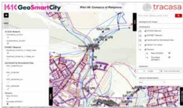
Figura 9. Información en tiempo real el flujo de agua (litros/segundo) que circula por la red
