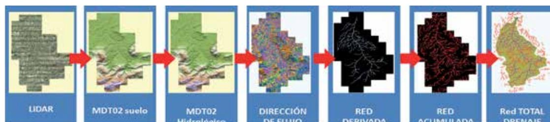
Figura 1. Fases en la producción de la RHA a partir de la nube de puntos LiDAR
