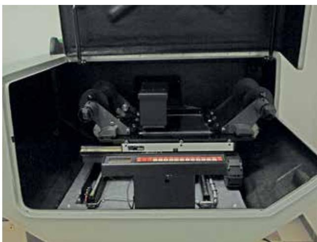
Figura 7. Escáner Leica DSW600
