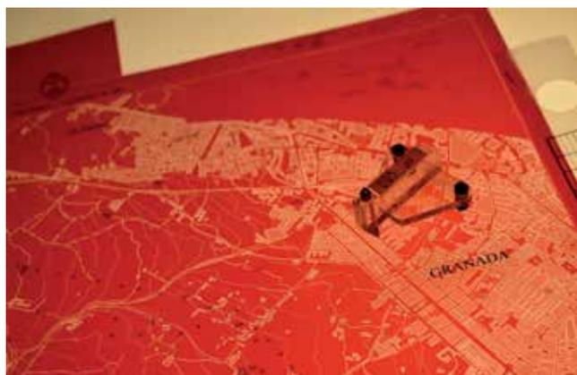
Figura 2. Hoja de «stabilene» con el cangrejo usado para el esgrafiado de las curvas de nivel
