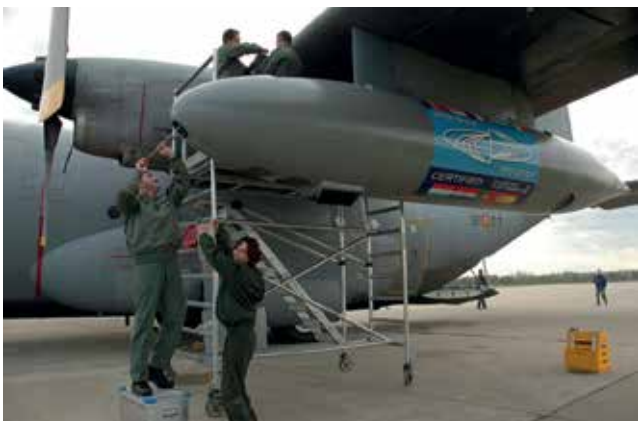
Figura 6. Instalación y desmontaje de los distintos almacenes de las cámaras insertadas en el depósito de combustible del C-130, así como comprobación de las distintas ópticas
