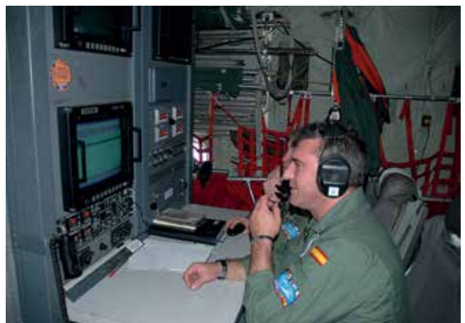
Figura 10. Operando desde la consola donde se ejecutan las órdenes de disparo de los distintos sensores instalados en la aeronave
