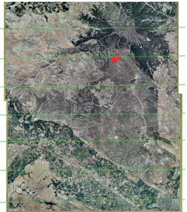
Figura 2.1. Vuelo escala 1:30 000 sobre Zaragoza (pasadas en verde). Se representa un vuelo del Gatewing X-100 de Trimble (rojo) de 400 imágenes
