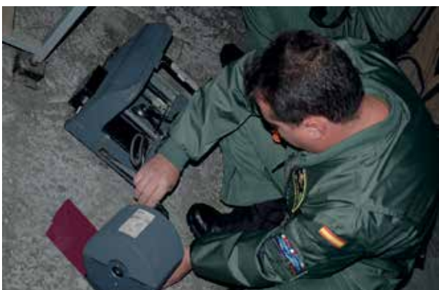
Figura 7. Montaje y desmontaje de los distintos almacenes de película
