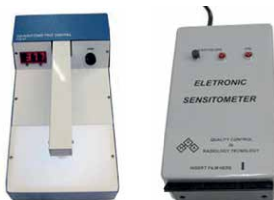
Figura 4. Densitómetros para la medición y lectura de las distintas tiras sensitométricas imprescindibles para la obtención del gamma correcto para el revelado de las distintas películas expuestas en las misiones
