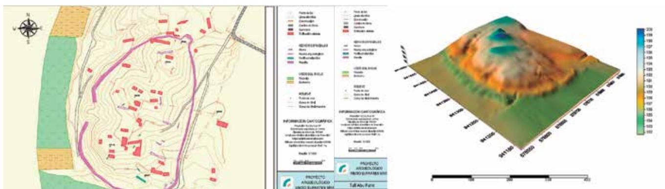
Figura 12. Plano Topográfico y Modelo Digital del Terreno realizado mediante el método IDW, del yacimiento Abu Fahd realizado por Ing. José Gaspar en el proyecto PAMES (2005).
