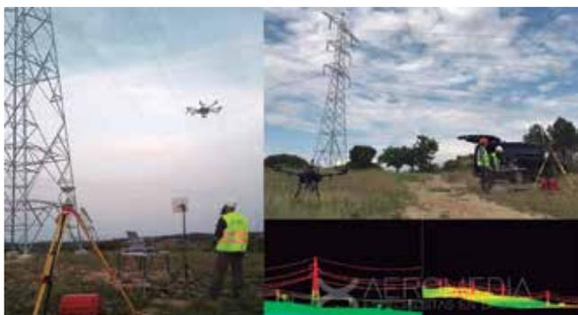
Figura 11. Trabajos realizados en Líneas Eléctricas Aéreas con sistema LiDAR+RPAS
