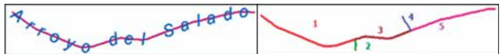
Figura 20: A la izquierda línea final que se adapta a la Anotación. A la derecha tramos 2 y 4 cortos que se deben eliminar
