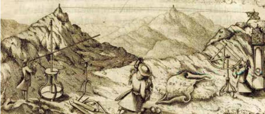
Figura 5. Los científicos que acudieron a medir el meridiano fueron bautizados como los caballeros del punto fijo, porque según los locales, buscaban el lugar exacto donde se hallaba el ecuador. En esta lámina se observan diferentes empleos del cuarto de círculo. Fuente: *Observaciones astronómicas y físicas* (1748), BNE
