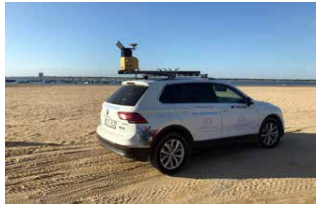
Figura 1. Vehículo con sistema Mobile Mapping IP-S3 de TOPCON embarcado empleado en la toma de datos para el SICA
