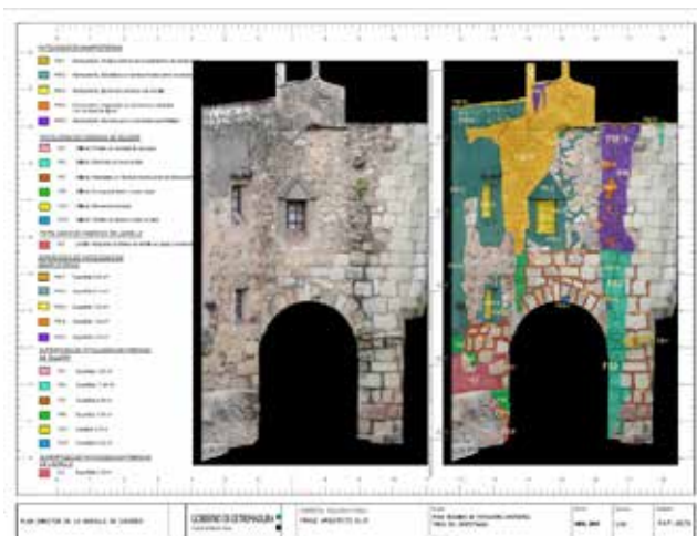
Figura 21. Estudio patológico de la muralla. Arco del Cristo
