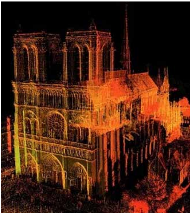
Figura 3- Nube de puntos LIDAR de la catedral de Notre Dame
