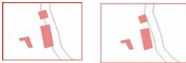
Figura 7. Separación de edificaciones con elementos lineales
