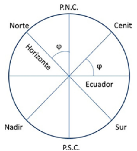
Sección meridional de la esfera celeste: la latitud \phi como altura del polo.
