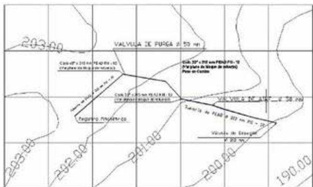
Figura 5. Proyecto de construcción de una conductora.
