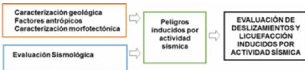
Figura 3. Flujograma general de la aplicación de métodos integrados para la evaluación de deslizamientos y licuefacción de suelos, inducidos por la actividad sísmica. Fuente: Autora.
