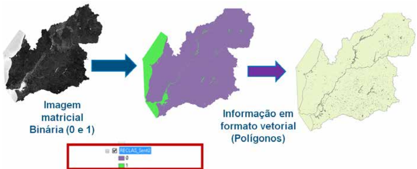
Figura 5 – Conversão de imagem raster para imagem reclassificada e para informação vetorial georreferenciada.
