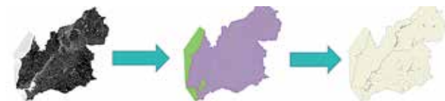
Figura 9. Imagem Matricial NDWI vs. Imagem Matricial Binária (0 e 1) vs. Planos de Água
