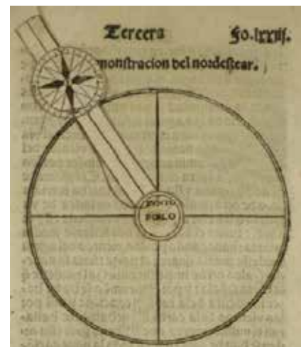
Nomograma con la Demostración del nordestear de la aguja magnética, según Martín Cortés.
