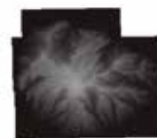
Figura 9. Ejemplo de petición API Coverages con la extensión geográfica bbox=(-18,28,-17,29) , en el Sistema de Referencia de Coordenadas bbox-crs=4258 y formato COG.
