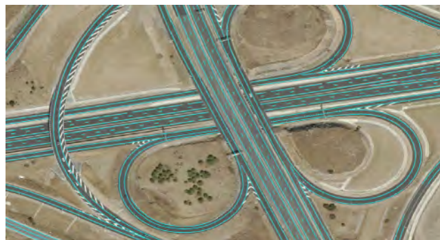
Figura 7. RTAD: resultado del algoritmo de I.A. de la detección de marcas viales lineales sobre imagen aérea
