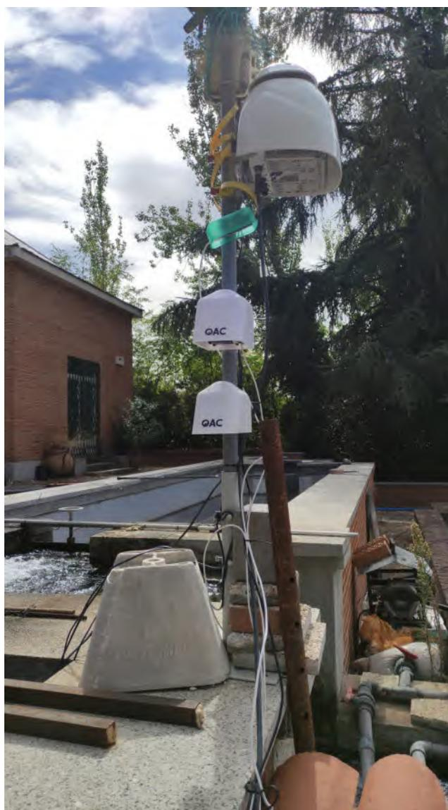
Figura 8. Sensores de NO<sub>2</sub> de bajo coste instalados en la Escuela Técnica Superior de Ingeniería de Montes, Forestal y del Medio Natural, Universidad Politécnica de Madrid.
