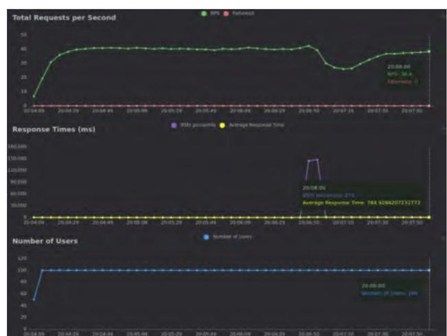
Figure 2. Resultados do teste de carga ao serviço SMOS WMTS, camada «Ortofotos 25cm-Norte Portugal-2021» em Mapproxy. Opções na framework Locust: 100 utilizadores, aumentando em 10 utilizadores de cada vez, por 4 minutos e seed aleatório 7210.
