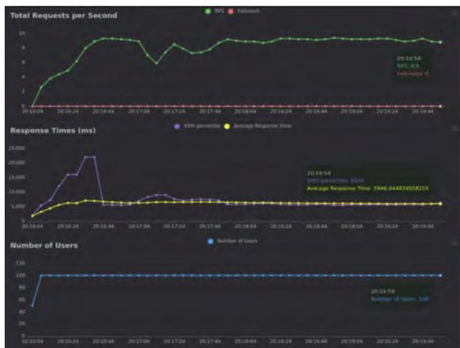
Figure 3. Resultados do teste de carga ao serviço PDOK WMS, camada (Ortofotos de 2023 a 8cm RGB). Opções na framework Locust: 100 utilizadores, aumentando em 10 utilizadores de cada vez, por 4 minutos e seed aleatório 1400.
