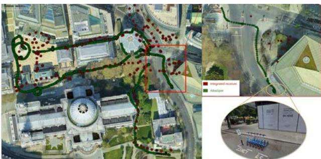
Figura 22. Patinete eléctrico con smartphone. Comparativa de posicionamiento procesado en la nube y posicionamiento absoluto (imagen cortesía de Albora Technologies)
