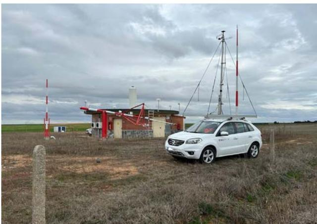
Figura 17. Calibración de sistema de radionavegación aérea VOR (imagen cortesía de Enaire)
