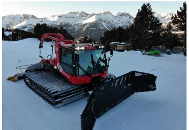
Figura 20. Medición de espesor de pistas de esquí (imagen cortesía de ARI).
