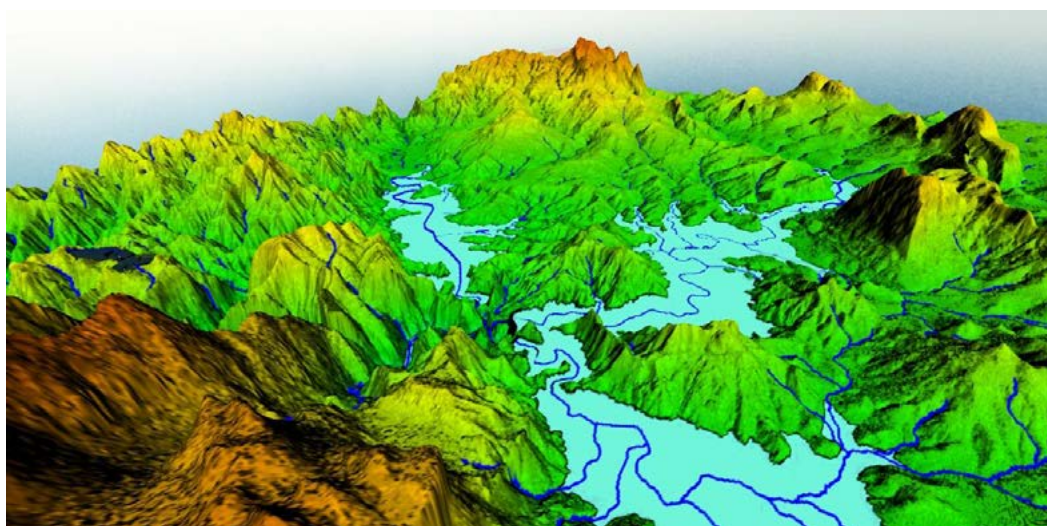
Figura 1. Red y embalses IGR Hidrografía sobre MDT LiDAR 1ª cobertura. Embalses del Guadalteba y del Guadalhorce.
