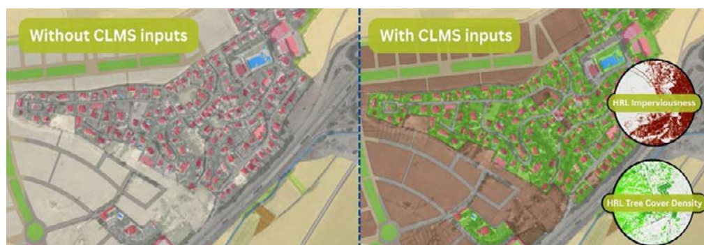
Ejemplo de mejora temática del SIOSE Alta Resolución, donde las clases de suelo no edificado o pavimentado son identificadas como vegetación urbana gracias a CLMS High Resolution Layers.
