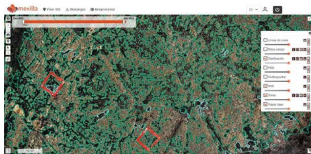
Imagen de la plataforma de gestión del proyecto visualizando un análisis basado en IA, de las imágenes capturadas en los vuelos, que permite identificar mejilla y otras especies de interés en la zona intermareal rocosa.
