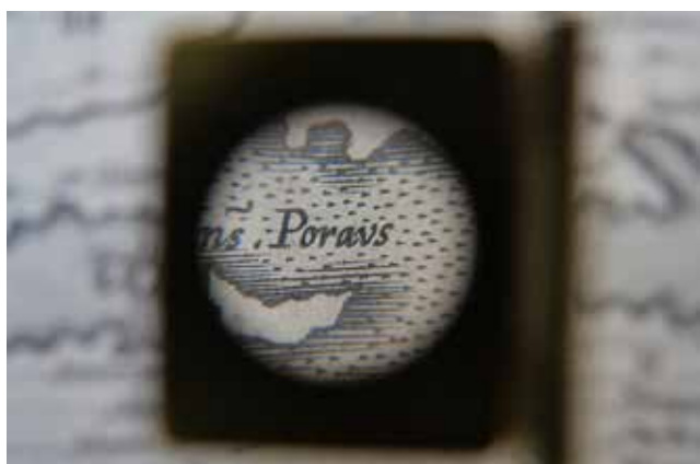
Figura 4. Se observa la característica típica de las buriladas (incisiones con el buril) con una entrada muy fina de la herramienta en la plancha metálica, luego se engruesa y por último, sale fina. También puede apreciarse la definición de las líneas tan rectas y nítidas.
