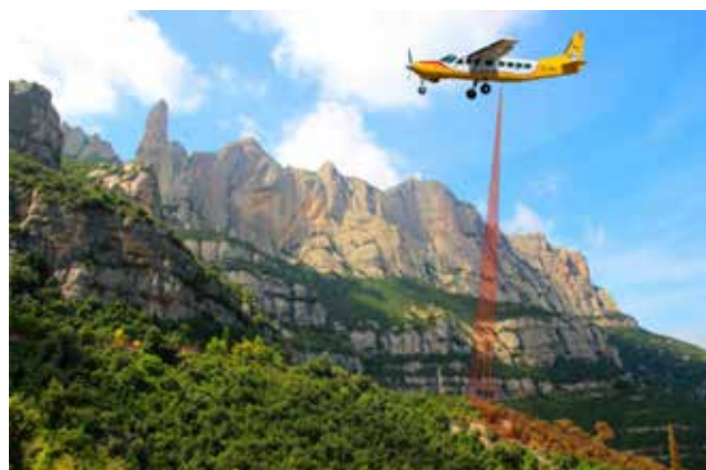
Figura 5. Simulación de la captura de nube de puntos LiDAR utilizando un sensor aerotransportado. Fuente: Just 2019.
