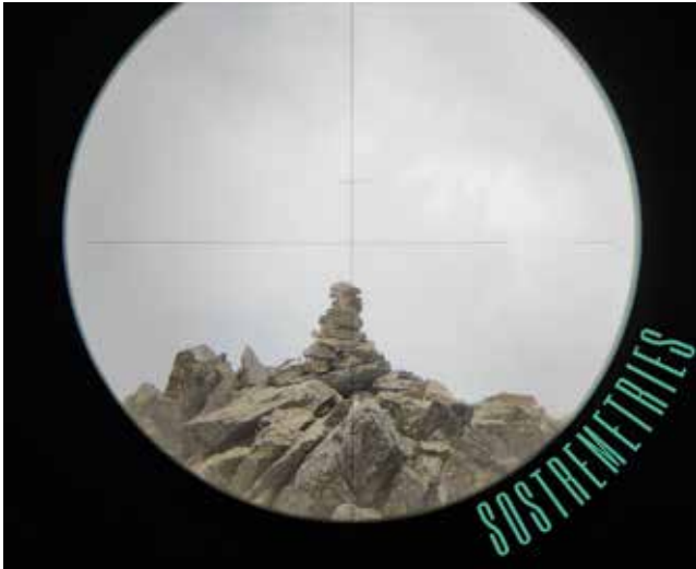
Figura 13. Visor del nivel óptico. La línea horizontal indica que el mojón de piedras que vemos a lo lejos está más bajo que el horizonte del observador. Fuente: Sostremetries 2021.
