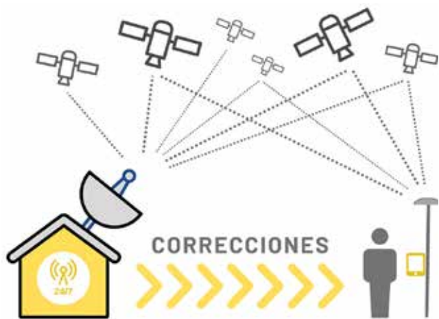
Figura 11. Concepto de GNSS diferencial. La estación permanente (izquierda) envía correcciones al usuario (derecha). Ambos deben observar un mínimo de satélites en común. Fuente: Sostremetries 2023.
