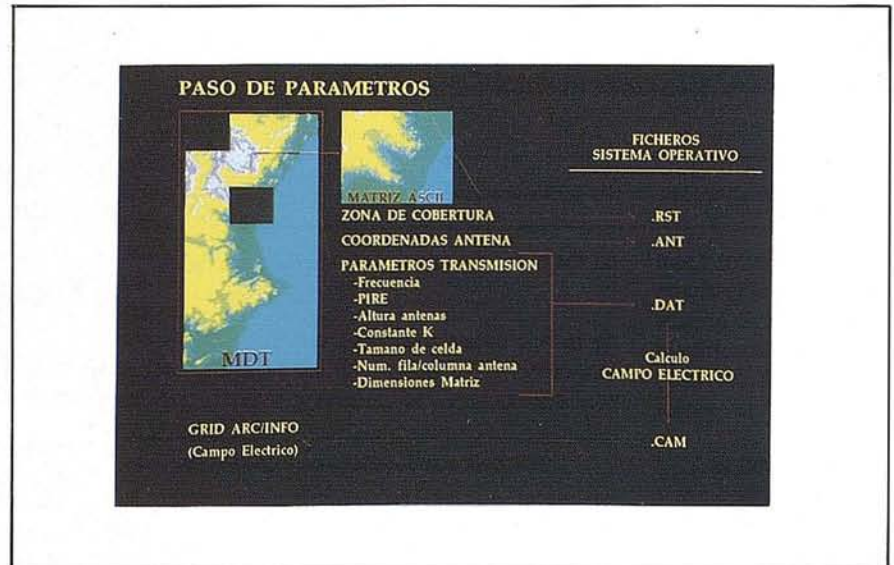
Fig. 1. Flujo de datos en el cálculo de coberturas radioeléctricas.
