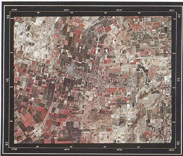
Fig.-2 Producto GEOSPOT sobre papel utilizable directamente para actualización cartográfica. Para la generación del mismo se han utilizado imágenes PAN y XS.
