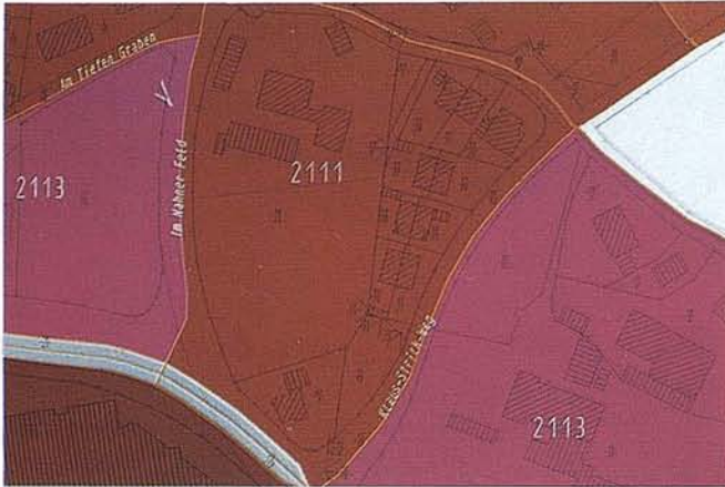
Fig. 7: Resultado de la superposición de datos ATKIS con datos ALK (Escala aprox. 1:1500)
