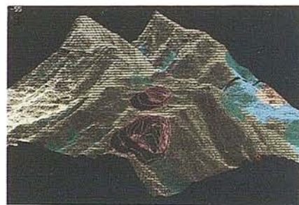
Fig. 6. Simulación del desarrollo de dos incendios sobre mapa topográfico con modelos de combustibles, realizada por el Sistema CARDIN.
