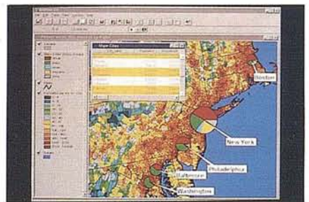
MapObjects es un conjunto de componentes GIS para desarrolladores de aplicaciones. Está compuesto de un control OLE y un conjunto de objetos programables que permiten a los desarrolladores añadir capacidades GIS a sus aplicaciones. Se puede utilizar en cualquier entorno de programación, como por ejemplo Visual Basic.
