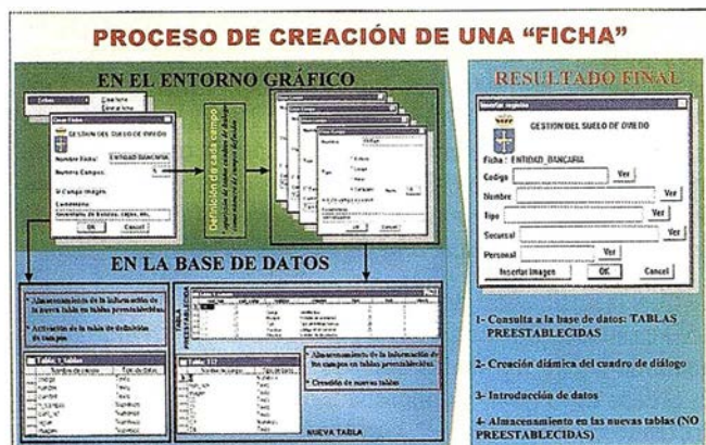
Figura 3.- Esquema explicativo de los pasos seguidos por el sistema para la creación automática de una ficha.
