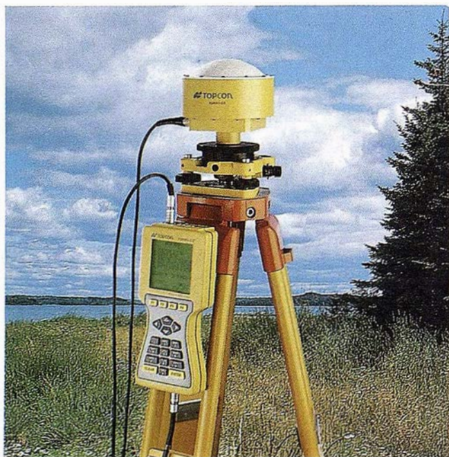
Turbo-Sil. Receptor GPS de doble frecuencia.
