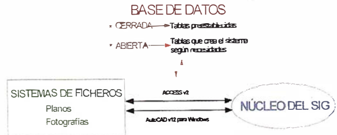
Figura 1.- Esquema general de la estructura del Sistema de Información Geográfico
