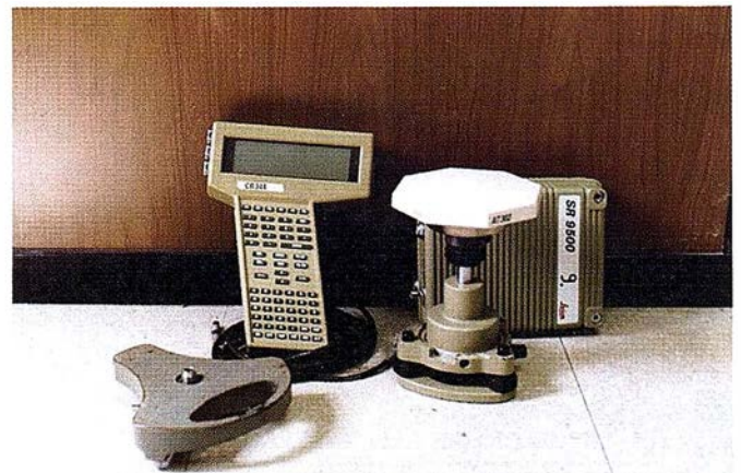
Figura 2. Sensor SR9500 (externo), antena y Controlador CR344.
