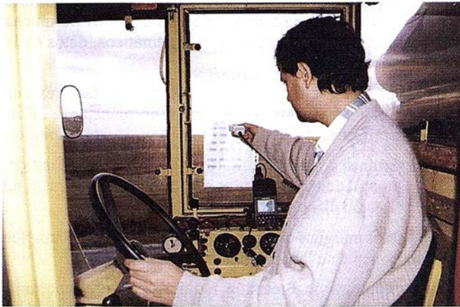
Cosechadora antigua equipada con un GPS de código "March II" y un scanner.
