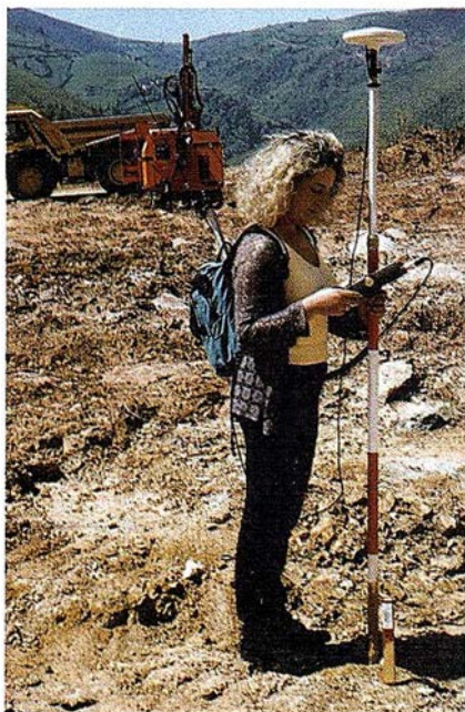
El departamento técnico de RÍO NARCEA realiza labores de posicionamiento de los límites del mineral utilizando el Sistema ASHTECH GPS GLONASS RTK.
