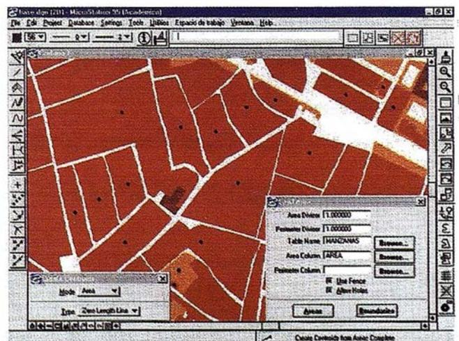
Fig 10.- Creación de centroides y asignación de la superficie en el campo AREA de la TABLA MANZANAS.
