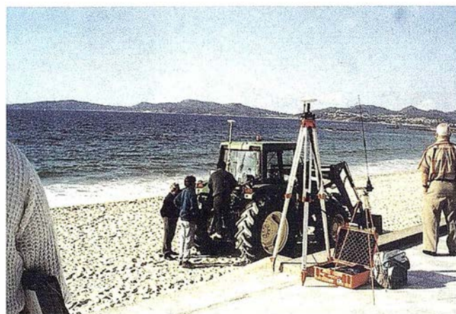
Foto2: Fijación de la antena receptora y rover sobre el vehículo
