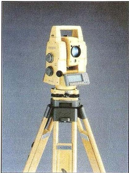
Topcon fue el primer fabricante en aplicar el enlace óptico de datos en instrumentos de topografía y laser. Este principio es utilizado en la estación total GRT-2000 con seguimiento de pendientes laser para motoniveladoras, que se introdujo en el
