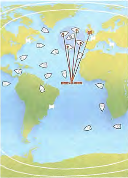
Esquema gráfico de mensajes de emergencia a barcos próximos a un desastre (Ilustr. Inmarsat)
