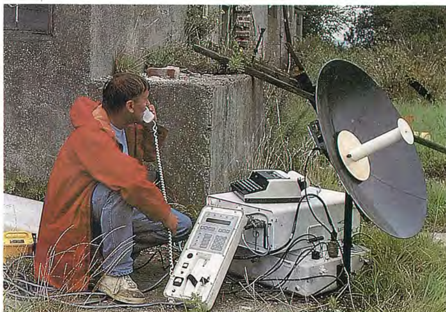
La nueva filosofía del uso de los satélites: "desde cualquier sitio en cualquier momento". Un pequeño equipo y una antena portátil son los ejes de los servicios de reporterismo electrónico (SNG) (Foto Inmarsat)
