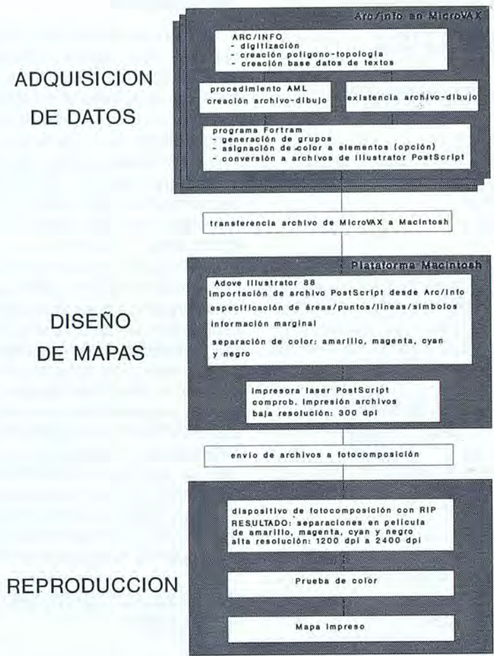
Figura 2. Línea de producción cartográfica con logical SIG y técnicas de autoedición (DTP). Schokker, ITC, 1989.
