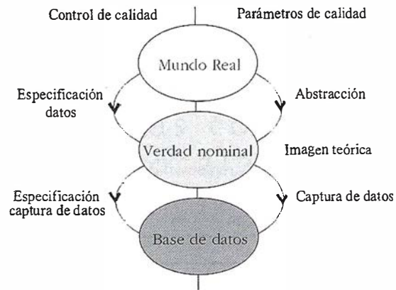
Figura IV.- Paso del mundo real a una BDG mediante la abstracción y la especificación de la captura.
