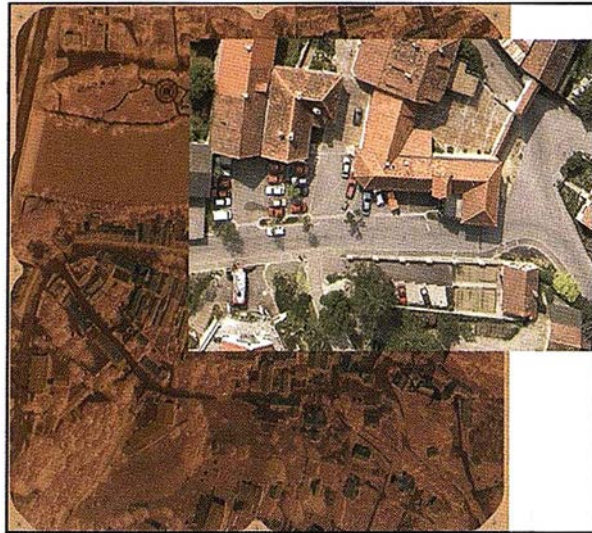
Figura 10: Escaneo de una película negativa en color enmascarada: la película negativa original muestra una máscara naranja de densidad 0,3D (ver la imagen grande del fondo). El escaneo es con 25 m de píxel y la sección positiva ampliada muestra una excelente reproducción de colores y tonos.
