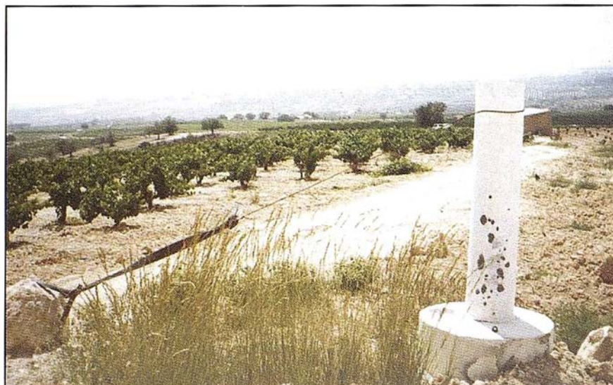
Figura 12. 4077 – Vértice Balsa, Godolleta (Valencia). 721/3-2/02: Señal invalidada, las obras para canalizaciones removieron los cimientos.
