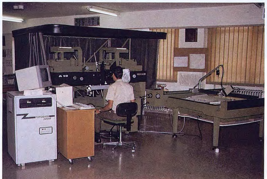
Restituidor WILD con equipo de captación digital
