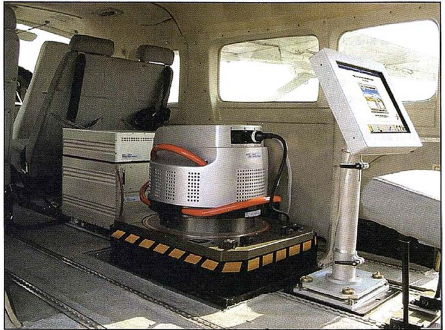
Sensor digital ADS40 montado en el avión de PASCO (Japón)
