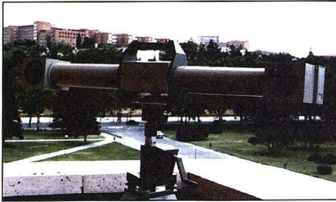
Fig.3- Bicámara Zeiss con base de 120 cm.
