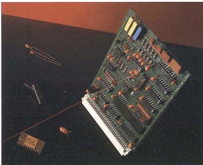
Tras la fase de diseño y testeo de un circuito, se lleva a cabo el montaje definitivo. La fotografía muestra como ejemplo una tarjeta perteneciente a un sistema de control modular una vez finalizado el proceso de fabricación y en condiciones para su fabricación en serie.
