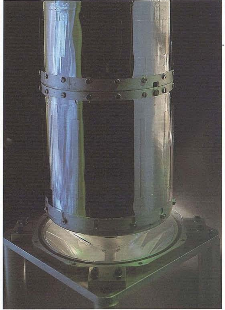
Interior de un criostato para instrumentación infrarroja en fase de mantenimiento, donde se ven las capas que protegen los componentes sensibles de la radiación originada en la estructura exterior, la cual se encuentra a temperatura ambiente.
