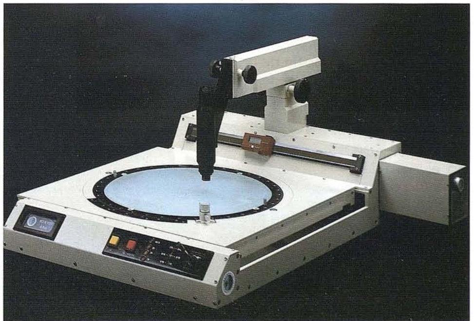
Microscopio para el control de calidad de los tamaños en los cortes de papel y otros productos. Este instrumento dispone de una mesa motorizada con una resolución lineal de 10 micras a lo largo de 25 cm de recorrido. Realizado para la empresa canaria LARSA (Litografía y Artes Gráficas Romero, S. A.).
