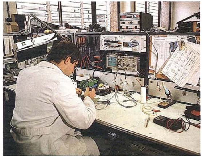
Antes de la fabricación definitiva de un prototipo, se realizan montajes de prueba para verificar las especificaciones técnicas impuestas por el diseño.
